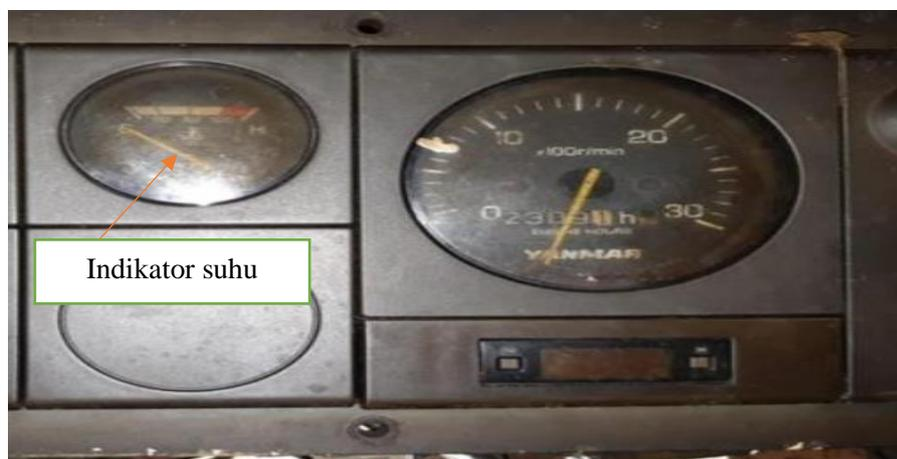
Gambar 2. 7 Indikator Suhu Mesin Diesel
