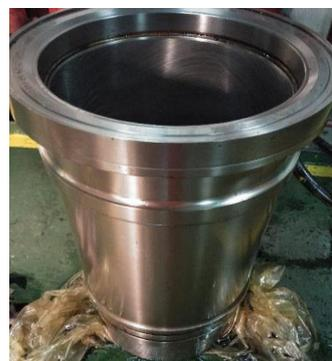
Gambar 2.6. *Cylinder Liner*
