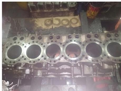
Gambar 4.10 Penggantian liner mesin penggerak utama
