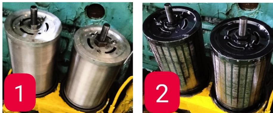
Gambar 4.9 Filter L.O Kotor dan Filter L.O Bersih
