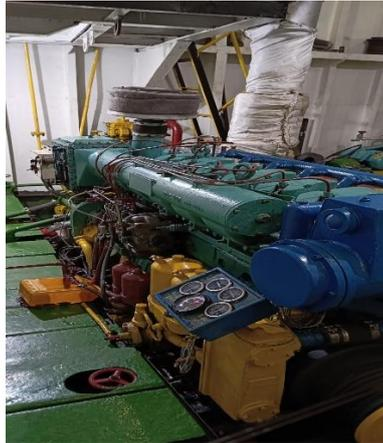
Gambar 4.3 Mesin Penggerak Utama
