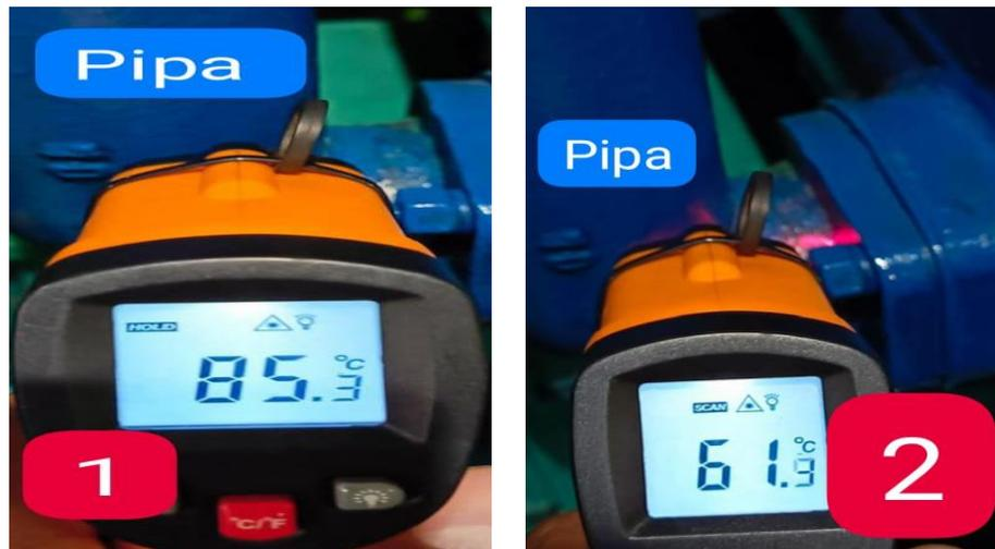
Gambar 4.5 Temperature Normal Air Tawar dan Naiknya Temperature Air Tawar
