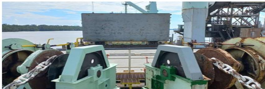
Gambar 1 Bagian Mesin Windlass
