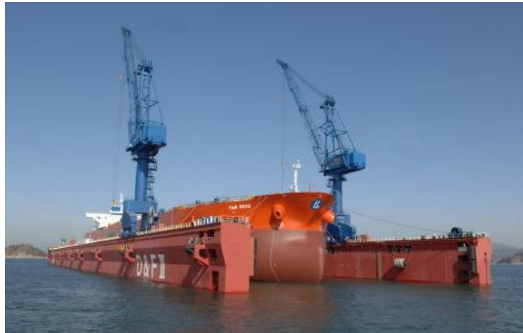
Gambar 2.3 Proses docking pada floating dock Sumber: Eva Ariani, 2019
